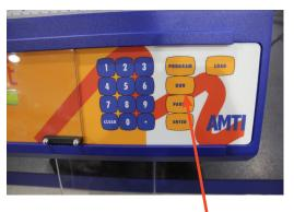
14. PRESS "RUN". SLIDE KEYPAD SAFETY SHIELD BACK TO RIGHT.
