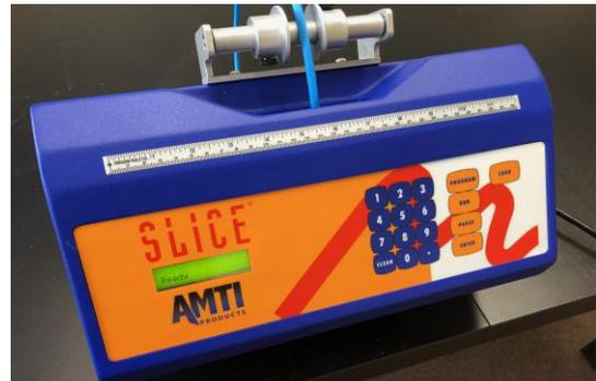
4. ADJUST TOP ROLLER GUIDE WITH MAETRAIL INSERTED. **MATERIAL MUST BE CENTERED.**
